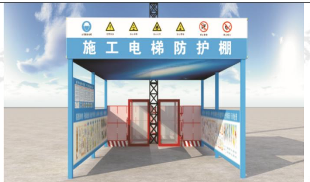
图 37 施工电梯防护棚
