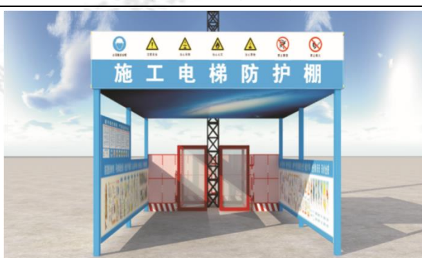
图 37 施工电梯防护棚
