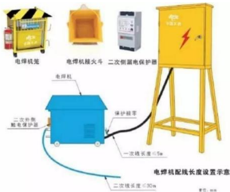
图 9-3 电焊机笼、接火斗、漏电保护器、电焊机配线长度参照图
