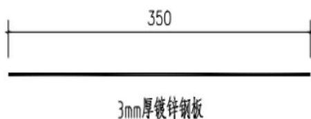
图六 环向施工缝镀锌钢板止水带详图
