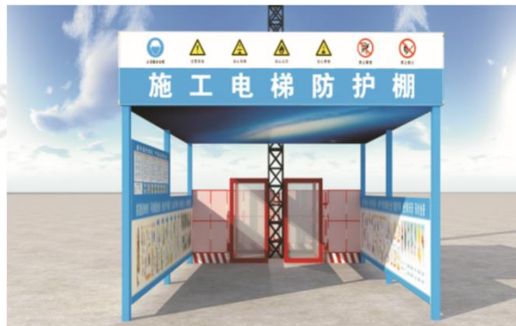
图 37 施工电梯防护棚
