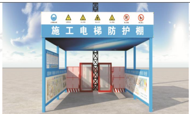
图 37 施工电梯防护棚
