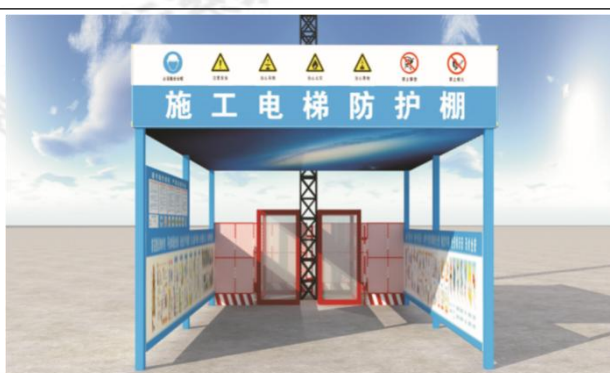
图 37 施工电梯防护棚
