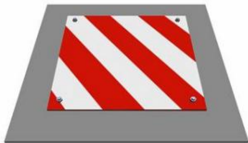
图 7-2 边长在 500~1500mm 的水平洞口防护效果图（颜色为黄黑相间）
