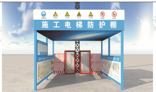
图 37 施工电梯防护棚
