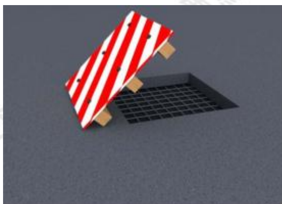
洞口浇筑前（预留洞位置钢筋不截断）
