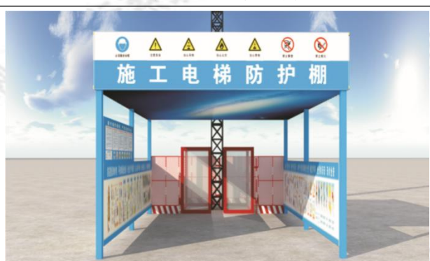
图 37 施工电梯防护棚
