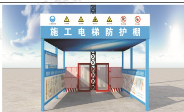
图 37 施工电梯防护棚
