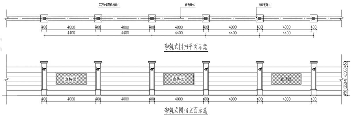
图 8 民国风格砌筑式围挡尺寸
