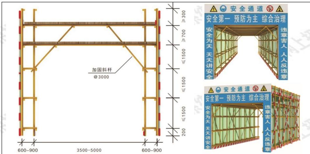
图 34 钢管扣件式防护通道
