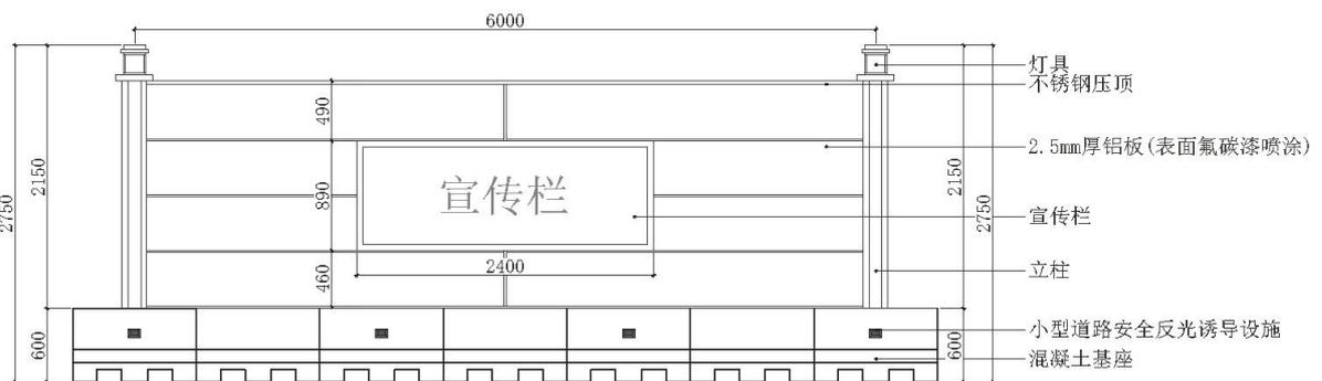
图 21 夹芯板装配式围挡尺寸
