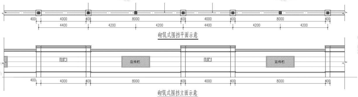
图 12 新中式风格砌筑式围挡尺寸
