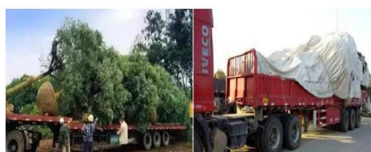
装车时土球向前，树梢向后，并用绑带或木架把树冠架稳，运输途中用苫布覆盖。
