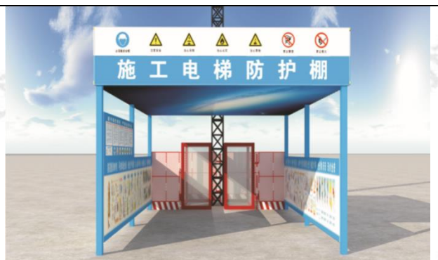
图 37 施工电梯防护棚
