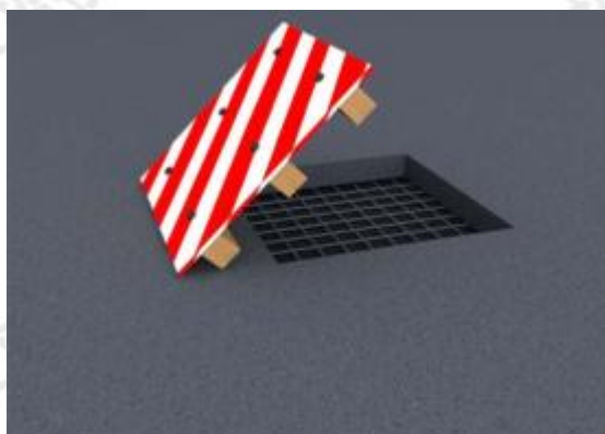
洞口浇筑前（预留洞位置钢筋不截断）
