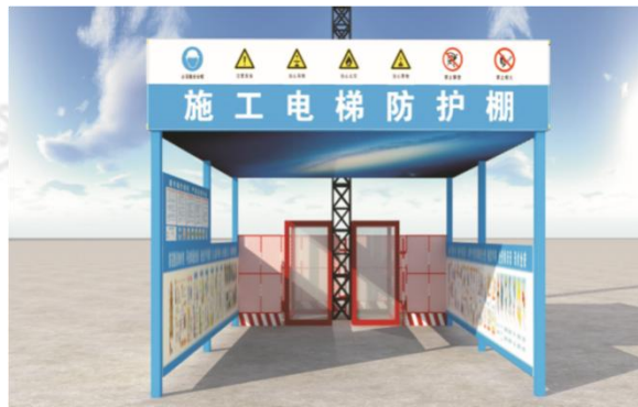
图 37 施工电梯防护棚
